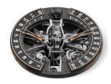
以黑色鈦金屬作主調,錶盤右面是0至60掃轉式逆跳指針分鐘顯示;錶盤左面是由白色阿拉伯數字時標構成的瞬跳式逆跳指針小時顯示。製錶師巧妙地利用陀飛輪以一分鐘轉一圈的特色,在陀飛輪框架上刻上秒鐘刻度並以紅色突出60秒的讀數。此外,錶盤的12時位亦設置了球狀的四日動力儲存顯示。
